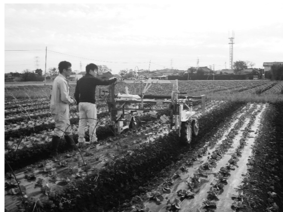
機械を使えば一人で支柱を楽に打てます
