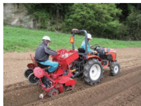
写真2：うね立て同時マルチ定植機による定植
