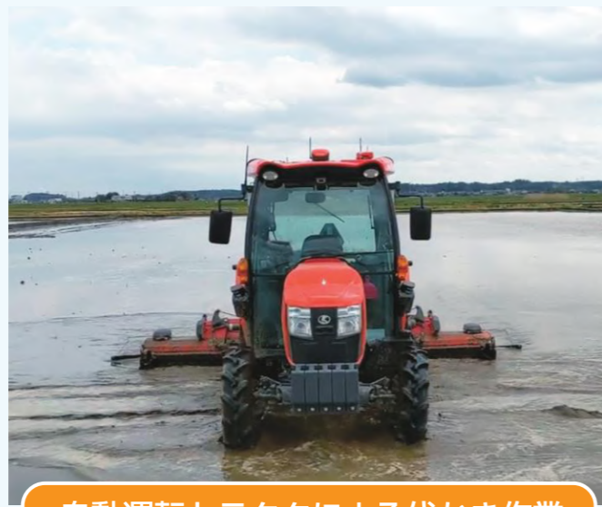
自動運転トラクタによる代かき作業
