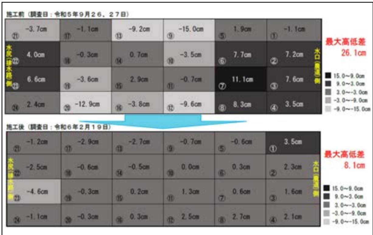
図2 レーザーレベル施工前後の地点別の高低差の推移
