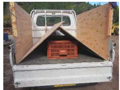
写真3. 三角屋根の構造
