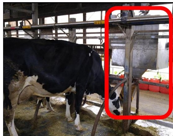
配合飼料の量を自動調整する自動給餌機
