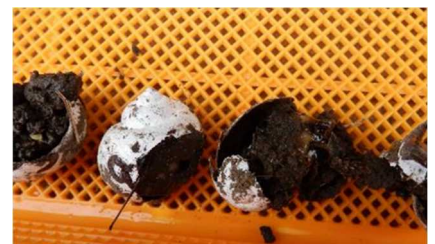
写真：ロータリーの刃で破碎された貝 ※試験のため、貝を白く着色しています。
