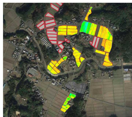
写真1 リモートセンシングにより作成されたNDVI（生育状況）マップ
