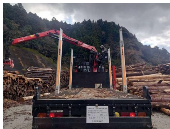
グラップル付き運搬車による間伐材の運搬
