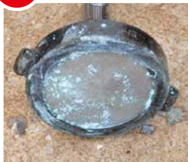
ストレーナーに 農薬の残りカスが付着しています
