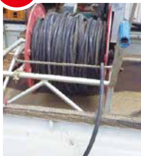
ホース内には前回使用した農薬が残っています (130mホースの場合、約10ℓ)
