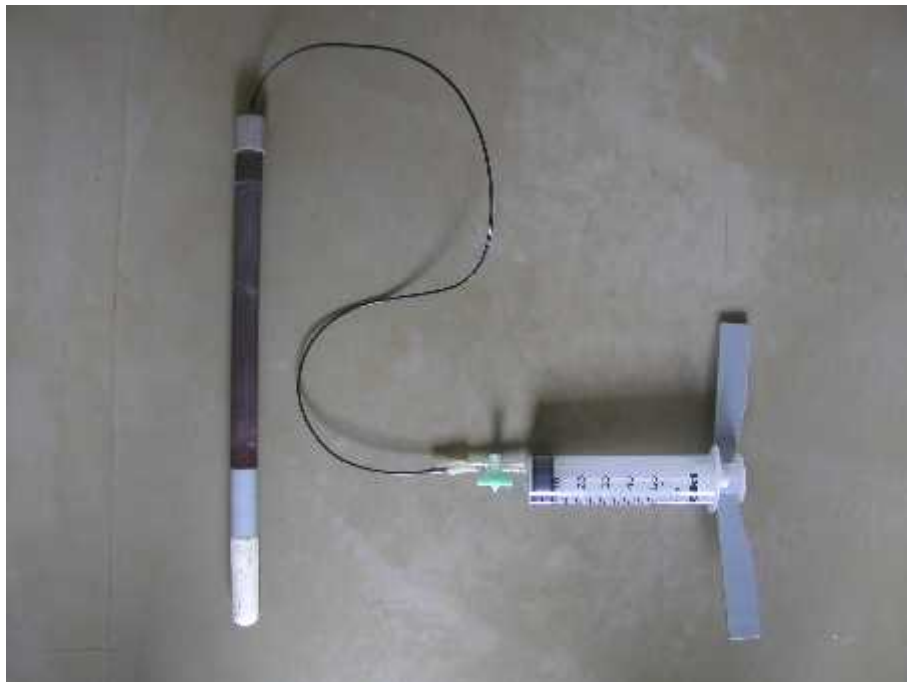
第Ⅱ-6-1図 土壌養液の採集に用いるポーラスカップ(左)と注射器型収集容器(右)
